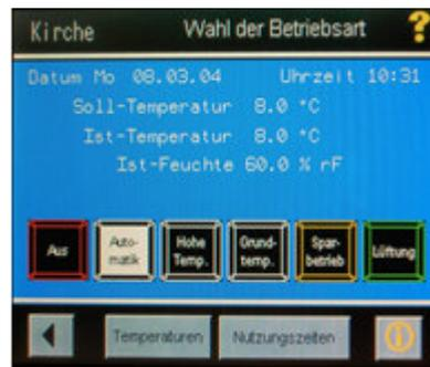
3. Zunächst werden für diesen Heizkreis die eingestellten Soll-Temperaturen angezeigt. Durch einen Tipp auf die Taste mit den zwei Pfeilen nach rechts werden sofort die einzelnen Stundenzähler angezeigt. Nach einem Tipp auf die Taste mit dem einen Pfeil nach rechts gelangen Sie ...
