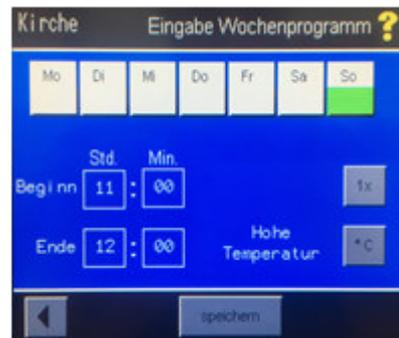
5. Tippen Sie auf das Feld „Std“ hinter „Beginn“ und geben Sie über die Tastatur zunächst die Startstunde, dann die Startminute, die Endstunde, und die Endminute ein. **Jede Eingabe mit der Taste „S“ sichern.** Schließen Sie die Tastatur über „Schließen“.
