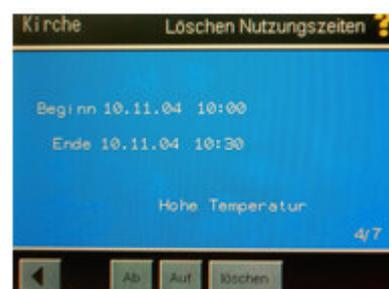
Es folgt eine Sicherheitsabfrage. Erst, wenn Sie hier auf die dann hinterlegte Taste „Löschen“ drücken, wird der Datensatz gelöscht. Sie können nun weitere zu löschende Datensätze aufrufen und löschen oder über die Taste mit dem Pfeil nach links zurück bis in den Eingangsbildschirm.
