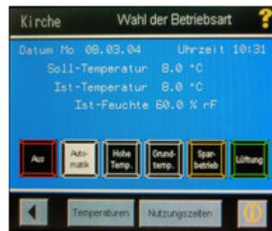
Über die 6 Funktionstasten im Eingabebereich kann die Betriebsweise der Heizungsanlage eingestellt werden. Je nach Heizsystem können einzelne Funktionstasten fehlen. So macht die Taste „Lüften“ bei einem Heizkreis mit Heizkörpern keinen Sinn und wird daher gar nicht angezeigt. Die Funktionen der jeweiligen Tasten sind wie folgt: (Kurzinformationen sind auch über das „?“ zu erreichen.)
