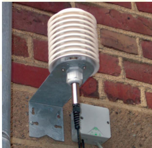
Wetter- und Strahlungsschutzgehäuse mit Montagewinkel, optional für den Außensensor
